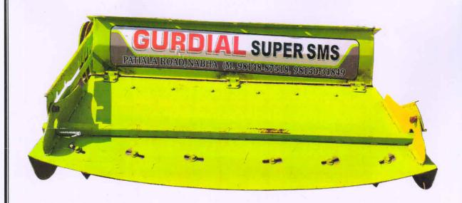
**GURDIAL SUPER SMS**, FITTED ON AS- SHAKTIMAN-930, SELF- PROPELLED COMBINE HARVESTER
